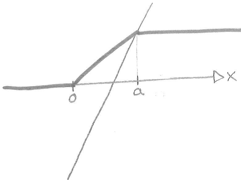
$$V(x) = \begin{cases} V=0 & x \leq 0 \quad (\text{ett val}) \\ -F_0 \cdot x & 0 \leq x \leq a \quad (\text{så att } V(x) \text{ är kont. i } x=0) \\ V_0 = -F_0 \cdot a & x \geq a \quad (\text{så att } V(x) \text{ är kont. i } x=a) \end{cases}$$
