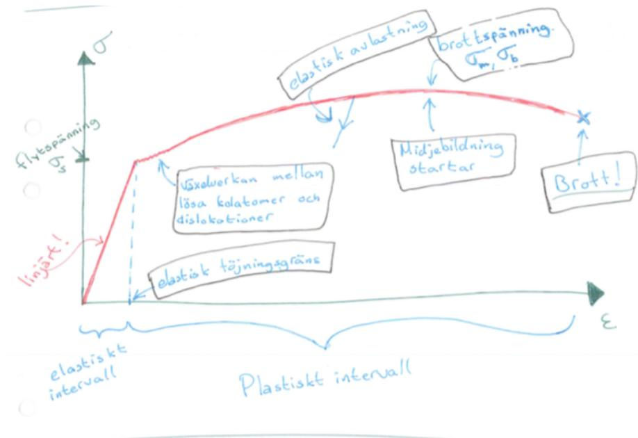
När man utsätter en stålstav för en dragkraft. Stål är ett polykristallint material. Den elastiska avlastningen är parallell med den första linjära delen av grafen. Om man passerar gränsen där den elastiska avlastningen börjar så får permanent deformation.
